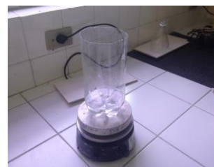
Figura 2 – Aquecimento de água na placa de amianto Fonte: o autor
